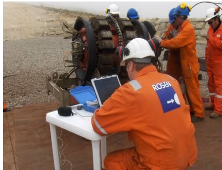
Perú LNG: Personal de ROSEN configurando memoria del raspa-tubos inteligente. Enero 2011.
