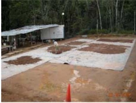
**Plataforma Cashiriari 1:** Vista área de zona donde se realiza el secado de los detritos que luego pasarán por el equipo de molienda y finalmente serán reinyectados en el pozo re-inyector de cortes de perforación.
