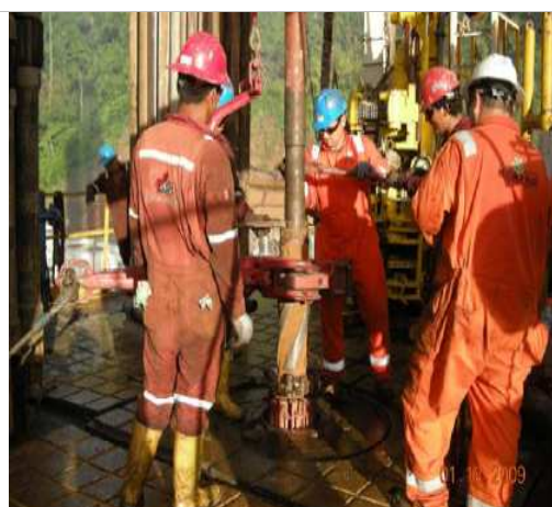
Plataforma Cashiriari 3: Vista del personal de perforación, trabajando en la instalación del BHA para realizar el corte de Core a la profundidad de 2979m.
