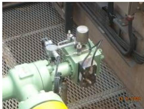
Plataforma Pagoreni A – Válvula lateral del cabezal del pozo
