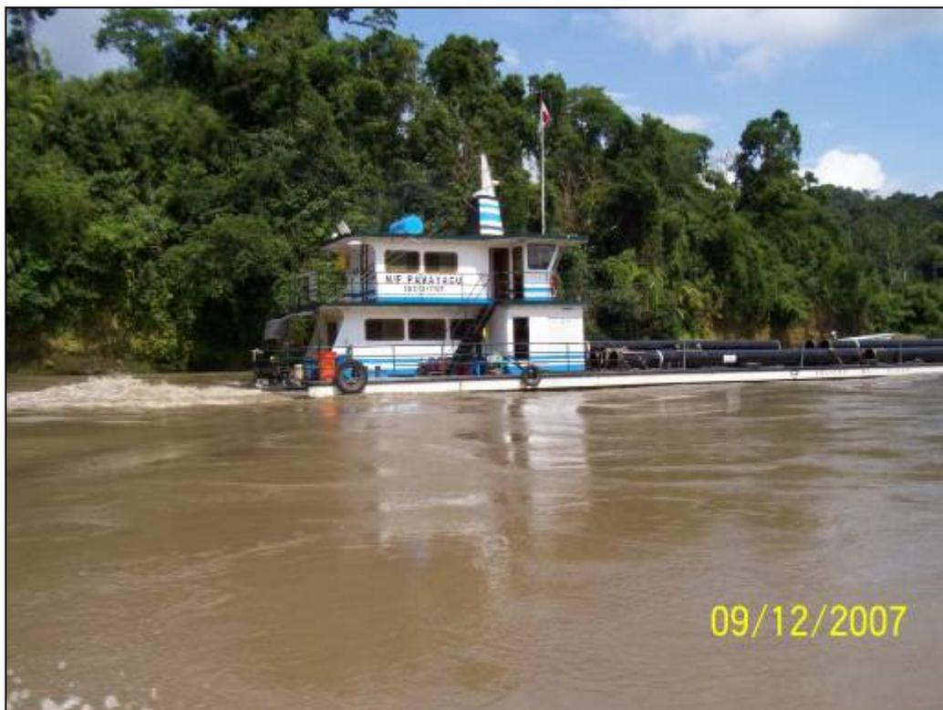
**Foto 6.** Vista de la Motochata Pavayacu de Pluspetrol trasladando ductos hasta el campamento base Malvinas.
