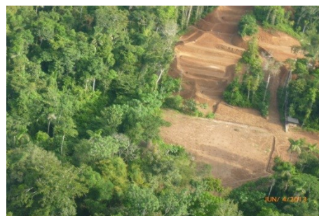
Repsol: KP 9+100 (FL Pagoreni A – Malvinas).- Tramo del DdV reconformado.
