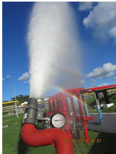
Prueba a flujo máximo con tubo pitot de un hidrante presión alcanzada 90psi.
