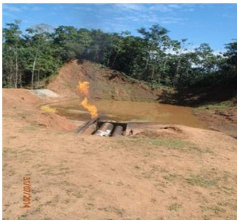
Pagoreni B: Diverter pit, una vez encendido el mechero se indica el desfogue del gas del pozo, la operación es inyectar agua fresca por el anular y derivar el desplazamiento del producto al diverter pit.
