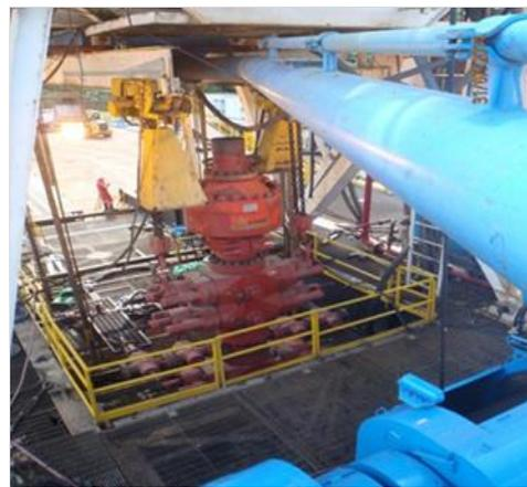
Pagoreni B: BOP instalado sobre el cabezal del pozo, se observa en la parte superior BOP anular y debajo el RAM doble donde está la compuerta ciega blind ram con el top ram y debajo presenta un simple ram.
