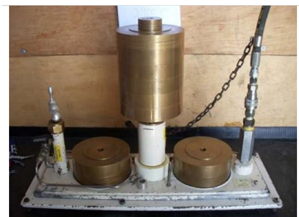
Balanza de peso muerto registrando una presión de 2990 PSI durante el desarrollo de la prueba de resistencia - 100% Pp. (Campamento Base "San Clemente")
